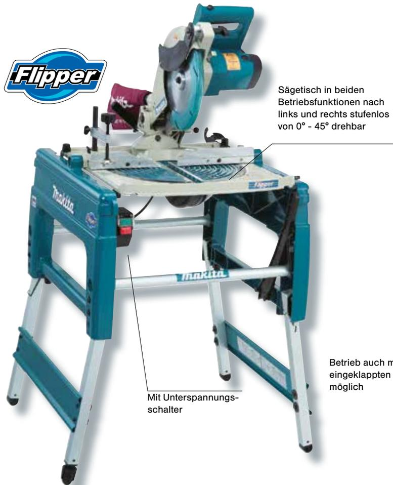
Sägetisch in beiden Betriebsfunktionen nach links und rechts stufenlos von 0° - 45° drehbar
