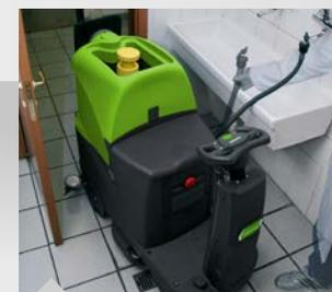
Frischwassertank mit Schlauch für Schnellbefüllung
